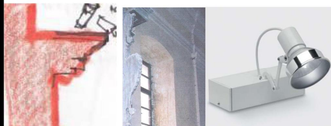
Obr.2.Osvětlení hlavního oltáře, reflektory jsou ukryty za přesahy bočních oltářů
