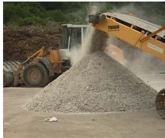
Abbildung 76: Gewinnung einer Gipsrohfraktion aus Gipskartonabfällen. Versuchsdurchführung im Rahmen des Projektes „Gipskartonplatten-Recycling“
