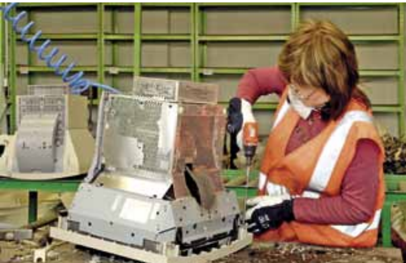
Například demontáž počítačového monitoru trvá zkušenému „likvidátorovi“ několik desítek minut. Téměř vše se díky demontáži podaří vytřídit
