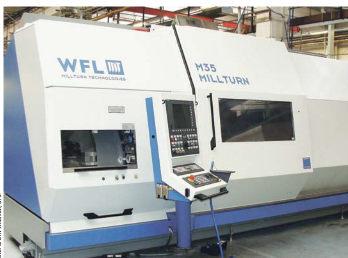
Multifunkční obráběcí centrum WFL M35 využívá Jihlavan, a. s., pro přesnou výrobu dílů určených pro letectví.
