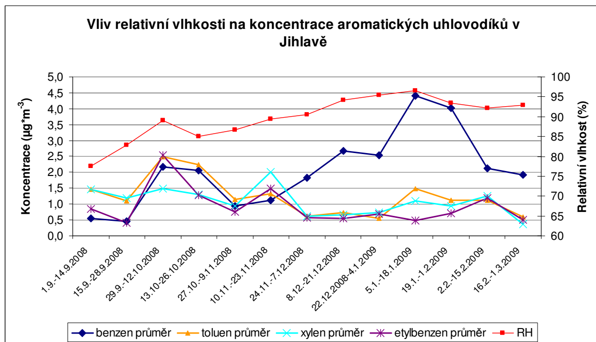
Obr. 57. Vliv relativní vlhkosti na koncentrace aromatických uhlovodíků, Jihlava, září 2008 – únor 2009
