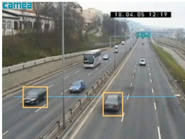
Detekce přejezdu vozidla přes virtuální čáru
